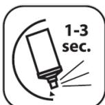
3. Для предотвращения забивания распылительного клапана, после завершения работ, необходимо перевернуть баллон клапаном вниз и несколькими нажатиями прочистить сопло до появления струи чистого газа.
