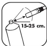
2. Обработку поверхности проводить равномерно тонким слоем с расстояния 15-25 см, сварочные работы начинать после высыхания состава.
